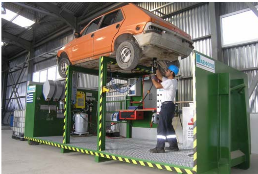
Εικόνα 4: Απομάκρυνση επικίνδυνων και τοξικών ουσιών
