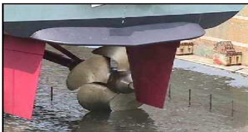
Εικόνα 2. Τοποθέτηση stern flaps σε ιδίου τύπου σκάφος (DDG-51)
