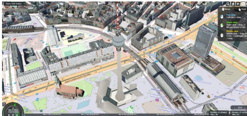
Εικόνα 37:3D σημασιολογικό μοντέλο του Βερολίνου. Περιλαμβάνει περίπου 550.000 κτιριακά αντικείμενα LoD2 με
