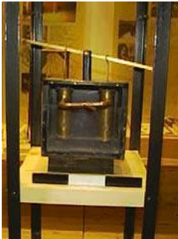
Αντλία του Κτησίβιου, δημιουργεί κενά αέρος για την αναρρόφηση ύδατος
