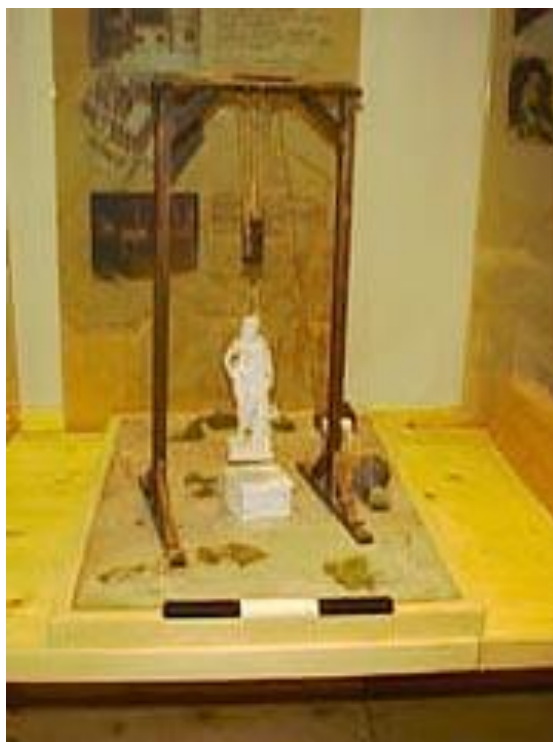
Ανυψωτική μηχανή (δίκολος) του Ήρωνος, για την ανύψωση δομικών υλικών
