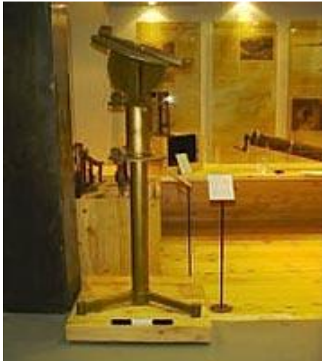
Αναπαράσταση της Διόπτρας του Ήρωνος, για ακριβείς γεωδαιτικές μετρήσεις στην επιφάνεια της Γης. Τεχνικό Μουσείο Θεσσαλονίκης.
