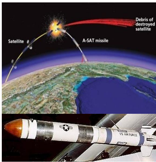
Εικόνες Δ5-Δ6. Τύφλωση - εξουδετέρωση δορυφόρου με laser από αερομεταφερόμενο μέσο. Εναλλακτικά, γίνεται να χρησιμοποιηθεί κατευθυνόμενος πύραυλος τόσο από ιπτάμενο μέσο όσο και από το έδαφος.
