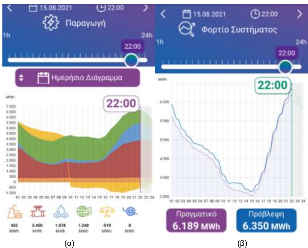
Εικόνα 21: (α) Συμμετοχή τεχνολογιών στην παραγωγή ενέργειας ΕΣΕ την στιγμή ΜΖ την 15/8/2021. (β) Διάγραμμα φορτίου συστήματος την 15/8/2021. Πηγή: ΑΔΜΗΕ 202 .
