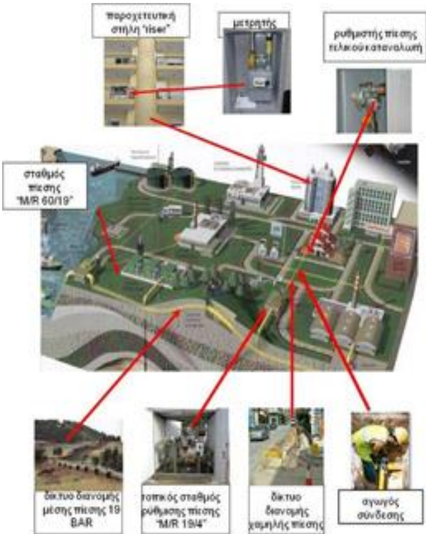
Εικόνα 7: Μεταφορά του φυσικού αερίου στα νοικοκυριά, στους χώρους δραστηριοτήτων του τριτογενούς τομέα και στις βιομηχανίες.
