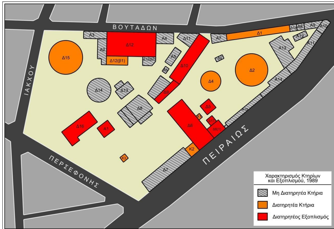
Εικόνα 50: Η διαμόρφωση του χώρου μετά τον χαρακτηρισμό των κτηρίων και του μηχανολογικού εξοπλισμού του εργοστασίου το 1989.
