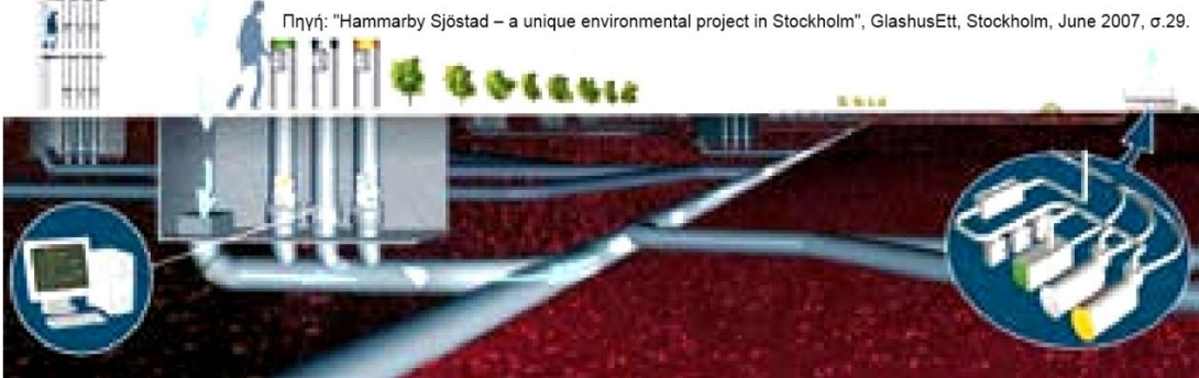
E-13. Στοκχόλμη, Hammarby Sjöstad, σύστημα περισυλλογής απορριμμάτων.
