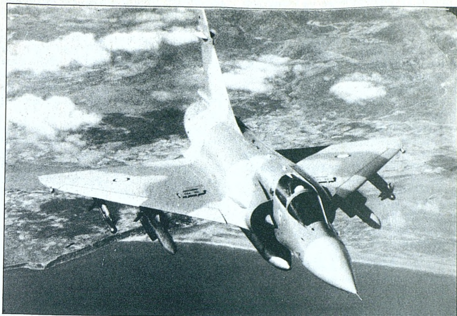
Ένα Mirage 2.000 πλήρως εξοπλισμένο. Στην άκρη των πτερυγίων του έχει αναρτημένους δύο πυραύλους τύπου MAGIC.
