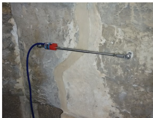
Εικόνες 62, 63. Εγκατάσταση συστήματος ενόργανης παρακολούθησης.
