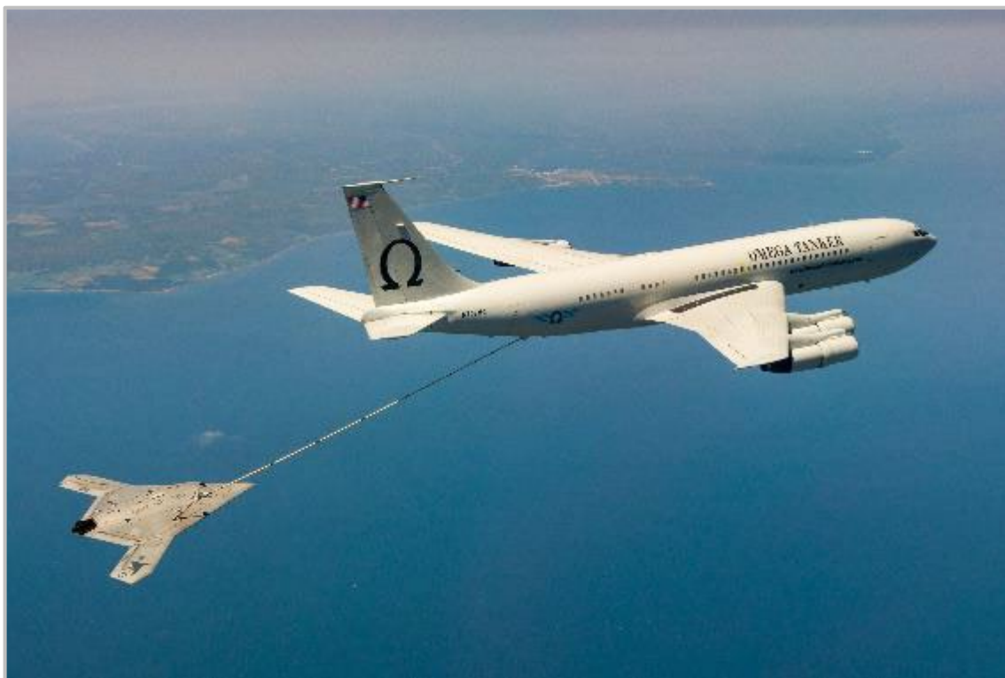
Εικόνα 11: Το αμερικανικής κατασκευής ΜΕΑ «X47-B» κατά τη διαδικασία αυτόματης πλήρωσης καυσίμων εν πτήση (in-flight refueling) από αεροσκάφος τύπου tanker 311 .
