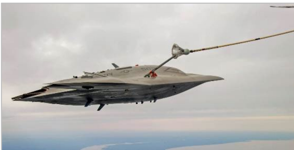
Εικόνα 10: Το αμερικανικής κατασκευής MEA «X47-B» κατά τη διαδικασία αυτόματης πλήρωσης καυσίμων εν πτήση (in-flight refueling) 310 .
