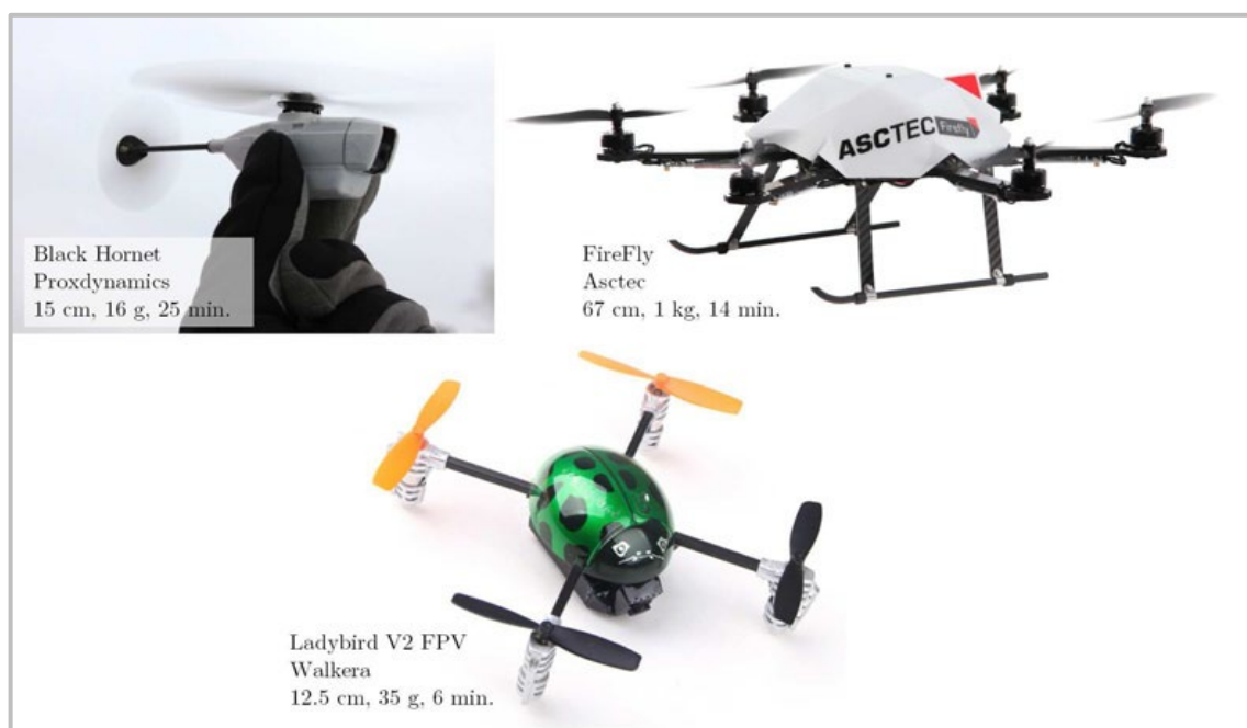
Εικόνα 1: Παραδείγματα ΜΕΑ με περιστρεφόμενα πτερύγια (έλικες): Το Black Hornet είναι το μικρότερο ΜΕΑ που χρησιμοποιείται από τον βρετανικό στρατό, το FireFly είναι ένα εμπορικού τύπου με έξι έλικες (hex-rotor). Το Ladybird είναι ένα mini-quadrotor για ερασιτέχνες, εξοπλισμένο κατάλληλα για μετάδοση ροής βίντεο σε πραγματικό χρόνο 301 ..
