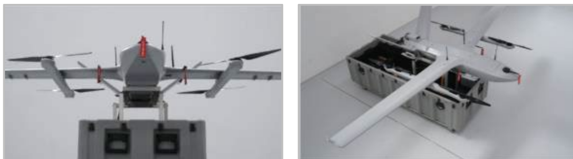
Εικόνα 2: Το ΜΕΑ υβριδικού τύπου «AR3 VTOL» της TEKEVER. Συνδυάζει σταθερά πτερύγια με έλικες, οι οποίοι του δίνουν τη δυνατότητα κάθετης απογείωσης 302 .
