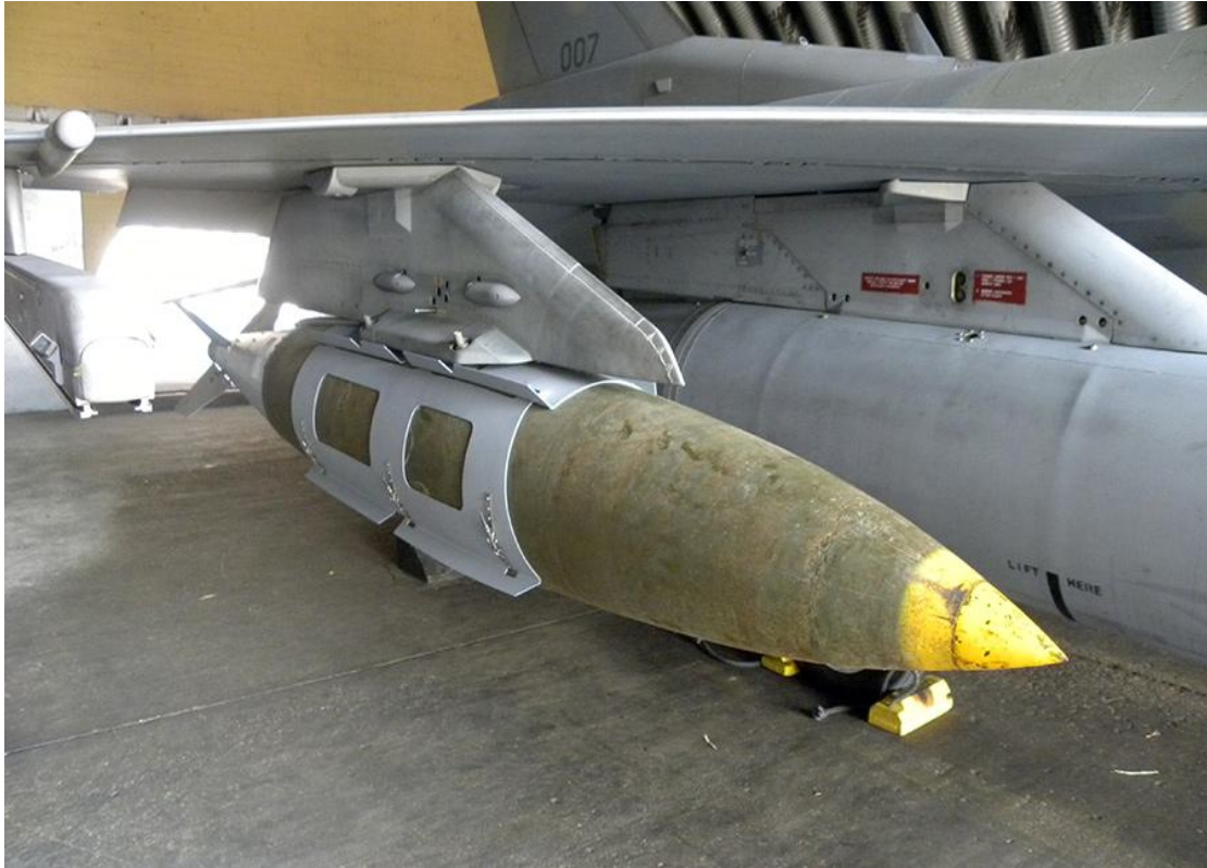
Εικόνα 33 Κατευθυνόμενο βλήμα άμεσης επίθεσης GBU-31 JDAM (Joint Direct Attack Munition) αναρτημένο σε μαχητικό αεροσκάφος F-16 (Πηγή: https://www.google.gr/search )
