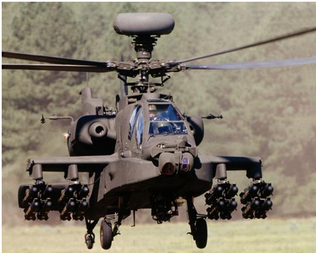
Εικόνα 23 Επιθετικό ελικόπτερο AH-64 DHA Apache Longbow εξοπλισμένο με 16 πυραύλους AGM-114 Hellfire (Πηγή: https://www.google.gr/search )
