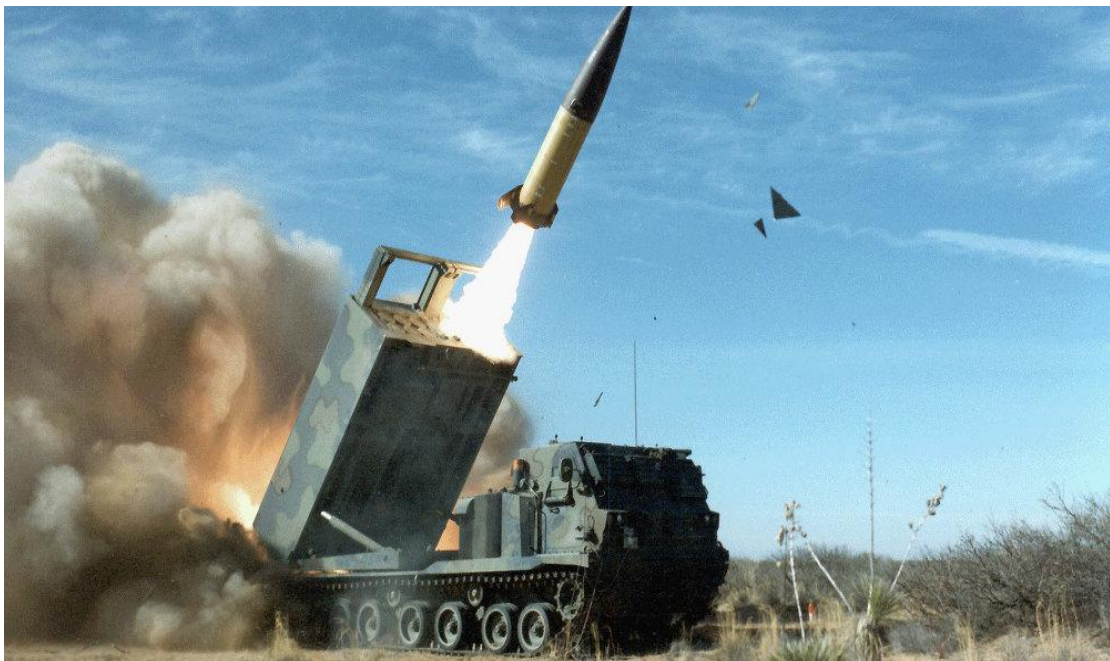
Εικόνα 22 Βολή πυραύλου MGM-140 ATACMS από σύστημα εκτόξευσης πυραύλων MLRS (Πηγή: https://www.google.gr/search )
