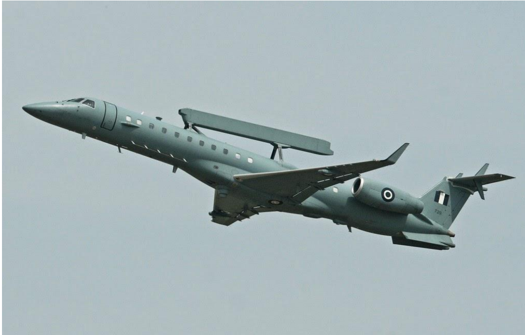
Εικόνα 37 Αερομεταφερόμενο Σύστημα Έγκαιρης Προειδοποίησης και Ελέγχου – (ΑΣΕΠΕ) EMB-145H Erieye της Πολεμικής Αεροπορίας (Πηγή: https://www.google.gr/search )
