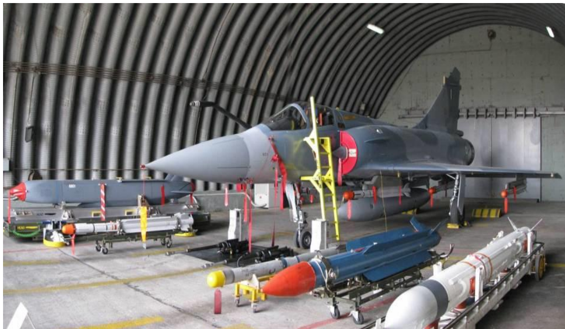
Εικόνα 30 Μαχητικό αεροσκάφος Mirage 2000-5 Mk2 της Πολεμικής Αεροπορίας. Δεξιά και αριστερά της φωτογραφίας διακρίνονται το βλήμα ναυτικής κρούσης Exocet AM 39 Block 2 και το βλήμα τύπου cruise SCALP-EG (Πηγή: https://www.google.gr/search )
