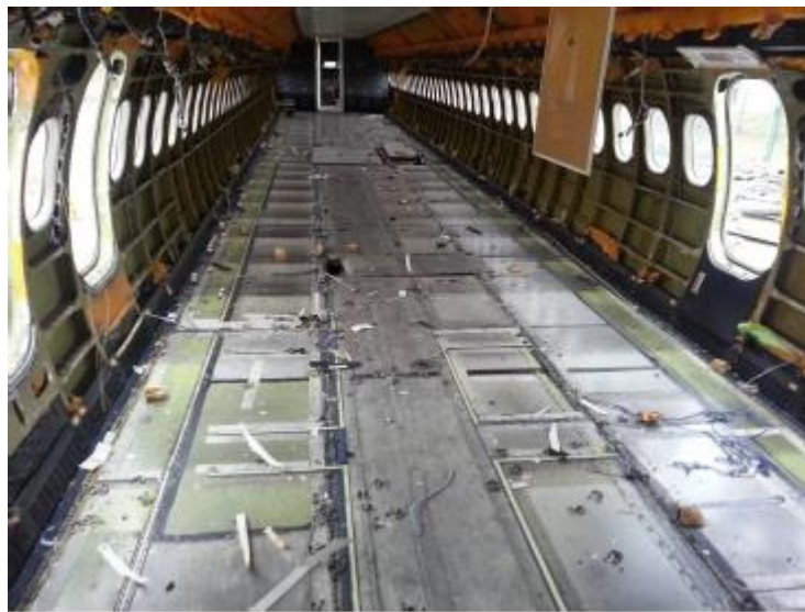
Εικόνα 12: Το αεροσκάφος μετά την απογύμνωση του εσωτερικού του 239
