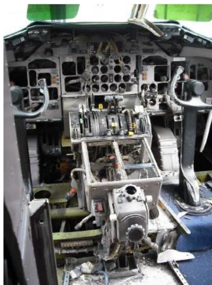
Εικόνα 9: Το πιλοτήριο μετά την αφαίρεση του αεροηλεκτρονικού εξοπλισμού 232
